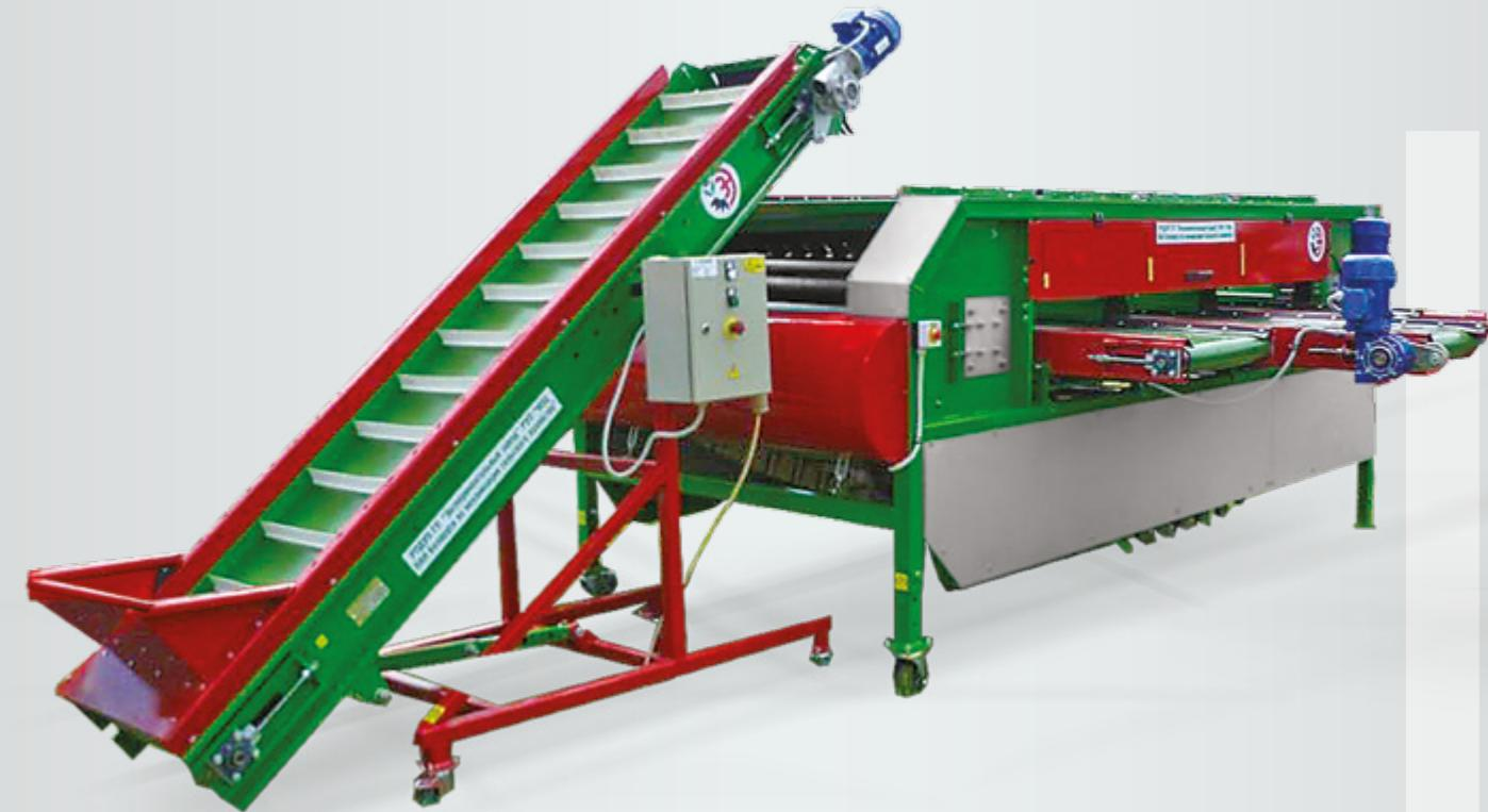
Конвейер перегрузной передвижной **ПРЕДНАЗНАЧЕН** для приёма овощей и равномерной, непрерывной подачи их далее по технологической линии.
