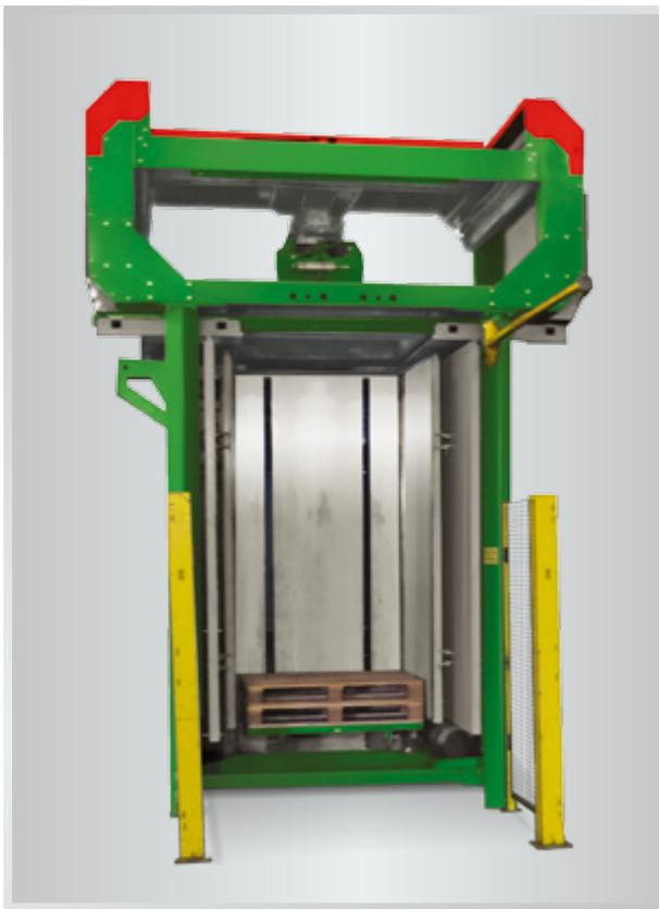
Паллетоукладчик **ПРЕДНАЗНАЧЕН** для укладки продукции, упакованной в мешки и сетки на паллеты.
