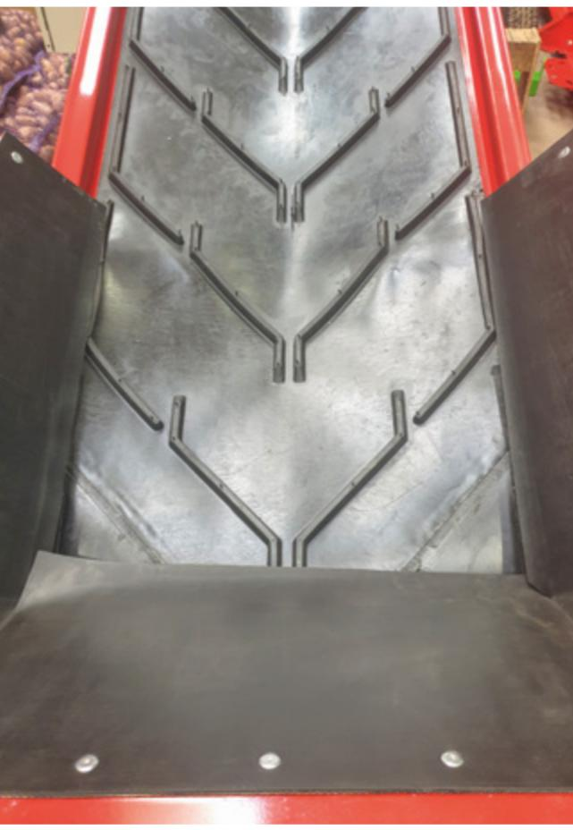
Конвейер наклонный КН-650 изготавливается только с изогнутым горизонтальным верхом (гуськом как называют фермеры)
