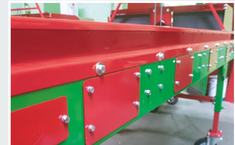
Стол переборочный роликовый СПР 10 (СПР 10-01) **ПРЕДНАЗНАЧЕН** для визуальной инспекции овощей поступающих на роликовое полотно и отбраковкой битых и поврежденных с дальнейшим их отбрасыванием в специальный разделитель.
