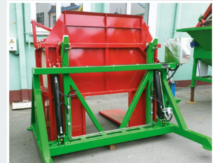
Опрокидыватель контейнеров OK-1 **ПРЕДНАЗНАЧЕН** для выгрузки продукта из контейнеров в приемный бункер (БП-600, КП-1000, КП-700 или другие накопители для последующей равномерной подачи на линию предпродажной подготовки овощей.
