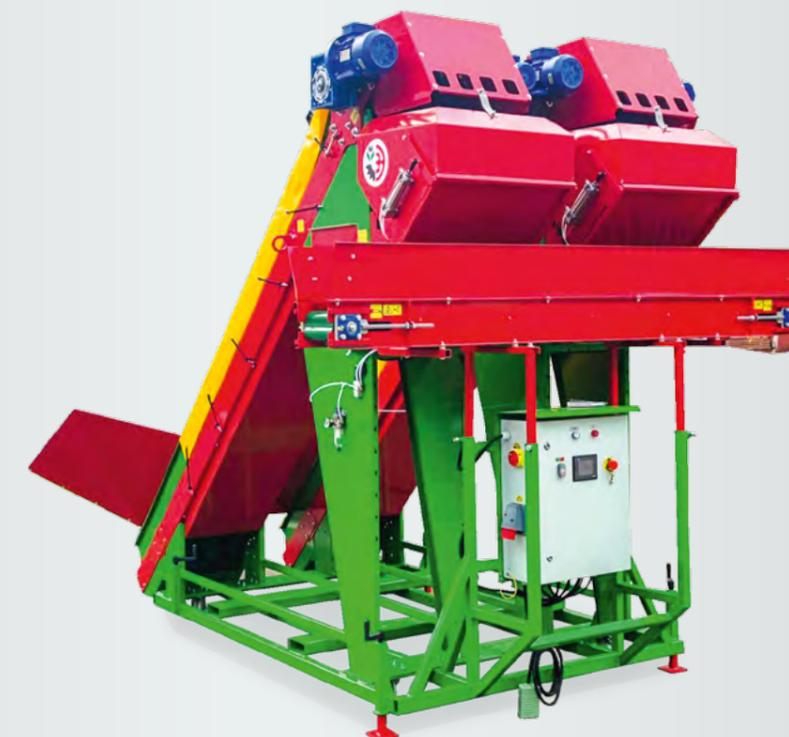
Весовой дозатор ВСП 50-03 **ПРЕДНАЗНАЧЕН** для точного взвешивания и дозирования продукта с дальнейшей подачей в любую автоматическую упаковочную машину [МАУС-25, МАУП-18, МАУР-5, МАУД-5, МАУД-5-3Б].
