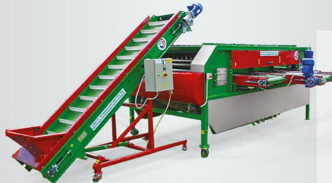
Конвейер перегрузочной передвижной **ПРЕДНАЗНАЧЕН** для приема овощей и равномерной, непрерывной подачи их далее по технологической линии.
