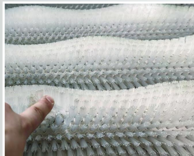
Машина сухой очистки картофеля МСОК-5 **ПРЕДНАЗНАЧЕНА** для предварительной очистки овощей от налипшей грязи, песка и придания им товарного вида перед фасовкой.
