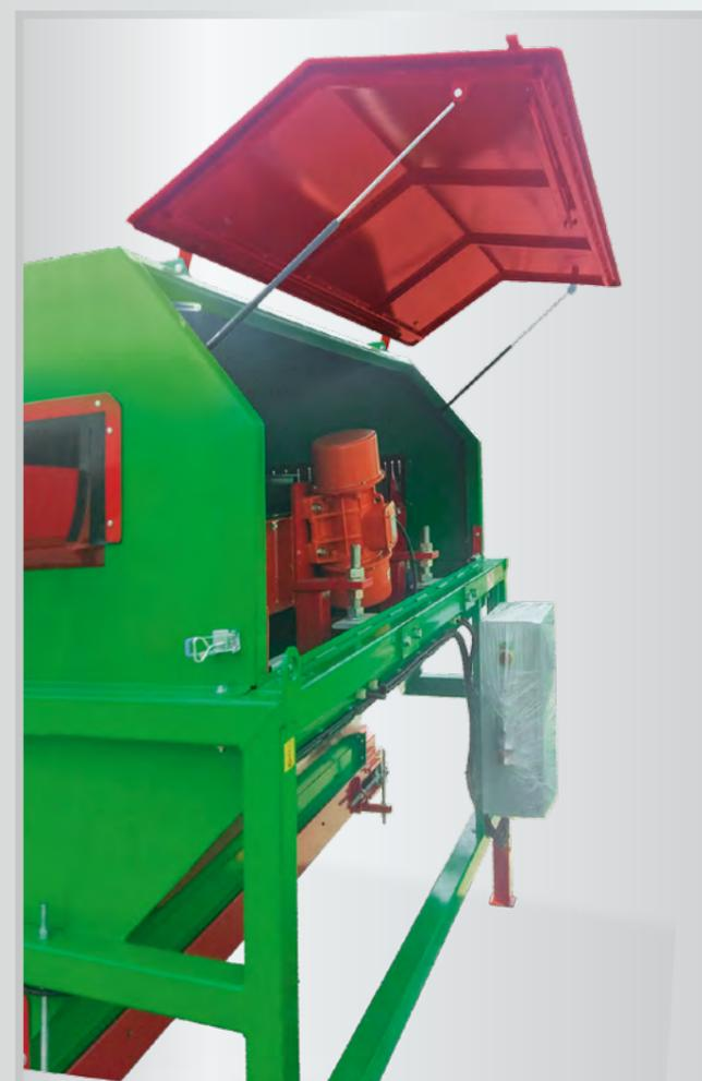
Обрезчик лука ОЛ-5 **ПРЕДНАЗНАЧЕН** для обрезки хвостиков лука и удаления верхнего слоя незакрепленной шелухи.
