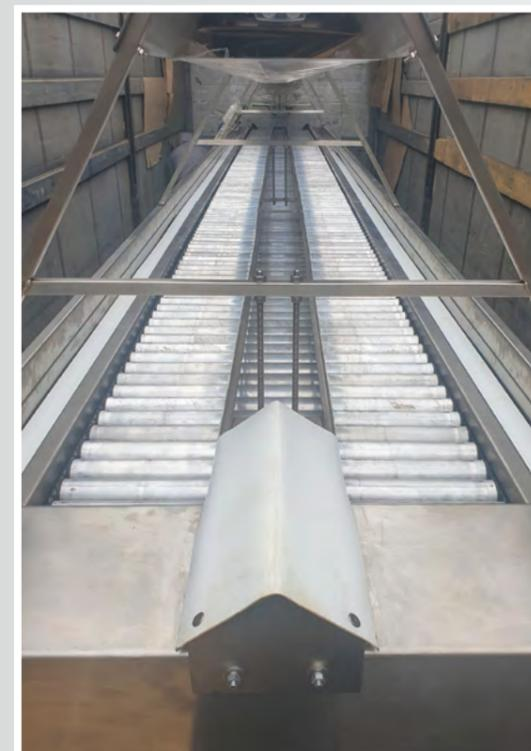
Стол переборочный роликовый СПР 10 (СПР 10-01) **ПРЕДНАЗНАЧЕН** для визуальной инспекции овощей поступающих на роликовое полотно и отбраковки битых и поврежденных с дальнейшим их отбрасыванием в специальный разделитель.
