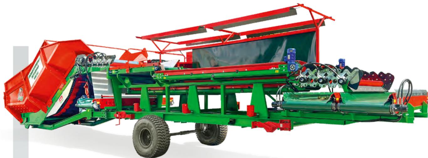
Пункт приемно-сортировочный ППС 20-60 КОМБИ предназначен для приема продукции с поля из самосвальных транспортных средств, отделение земли и вороха и сортировки продукции на две фракции. Комплекс выполнен в единой раме с двумя ленточными инспекционными столами, для работы персонала непосредственно в процессе приемки овощной продукции с поля.
