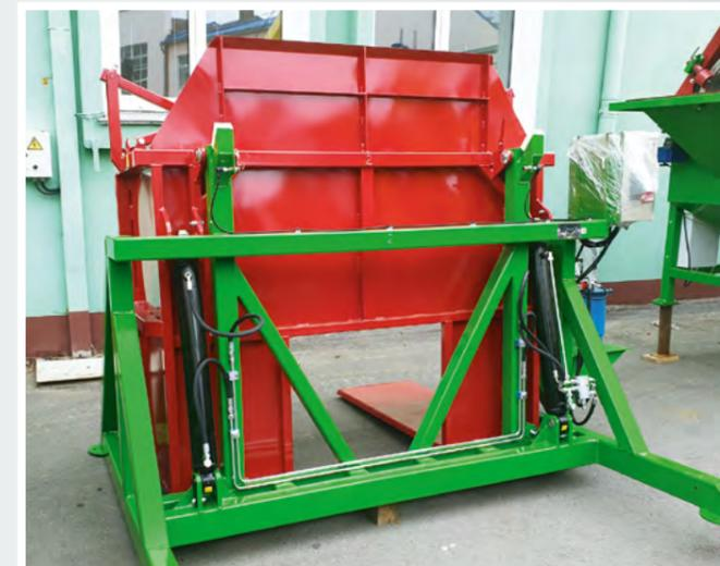
Опрокидыватель контейнеров ОК-1 **ПРЕДНАЗНАЧЕН** для выгрузки продукта из контейнеров в приемный бункер (БП-600, КП-1000, КП-700 или другие накопители для последующей равномерной подачи на линию предпродажной подготовки овощей.
