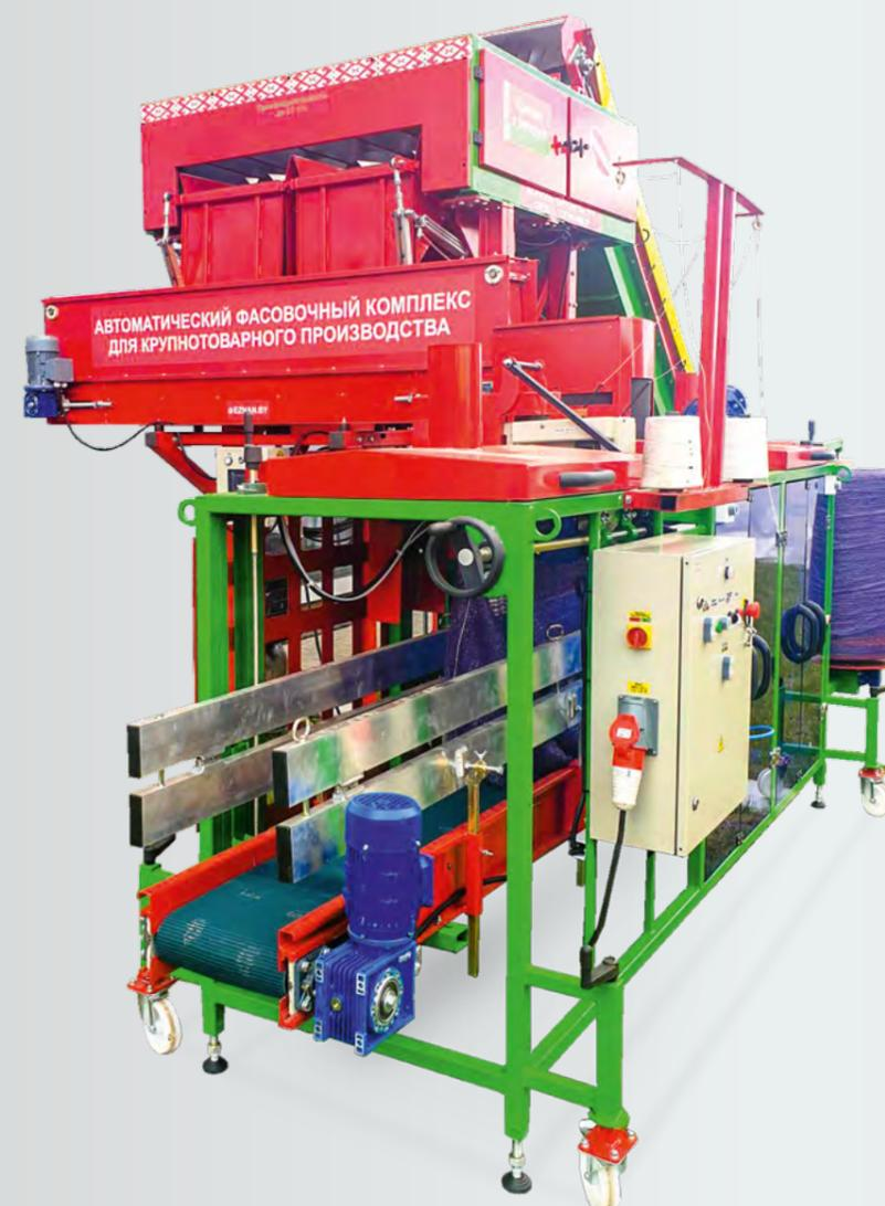
Дозатор весовой ДВ-25 **ПРЕДНАЗНАЧЕН** для точного высокопроизводительного взвешивания и дозирования продукта с дальнейшей подачей в любую автоматическую упаковочную машину (МАУС-25, МАУП-18 и другие).
