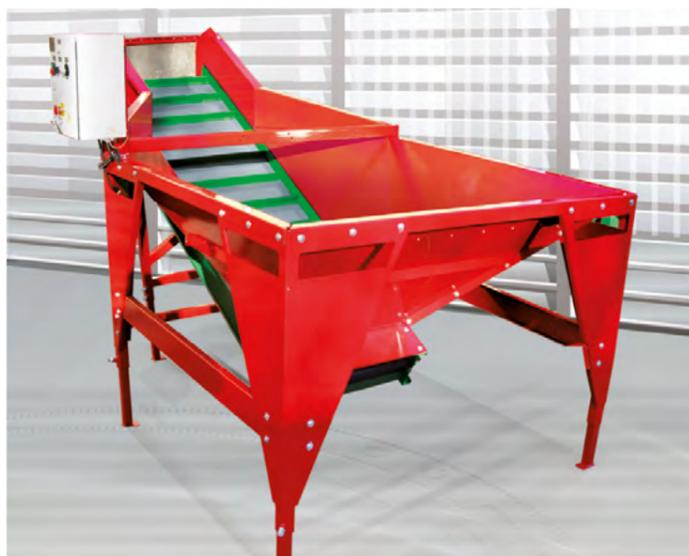
Приемный бункер БП-600 **ПРЕДНАЗНАЧЕН** для кратковременного накопления продукта из Биг-Бегов, мешков, транспортеров и равномерной подачи овощей на линию фасовки.
