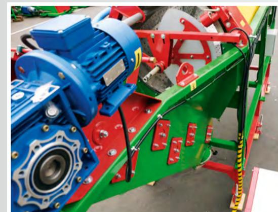
Машина для мойки корнеплодов УМК-10-01 **ПРЕДНАЗНАЧЕНА** для высокопроизводительной и эффективной мойки продукта (картофель, морковь, свекла).
