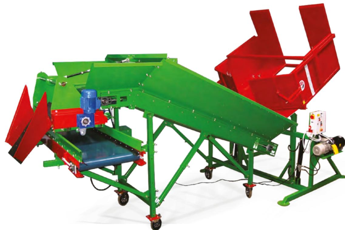
Конвейер приёмно-загрузочный **ПРЕДНАЗНАЧЕН** для приема овощей и равномерной и непрерывной подачи их далее по технологической линии.
