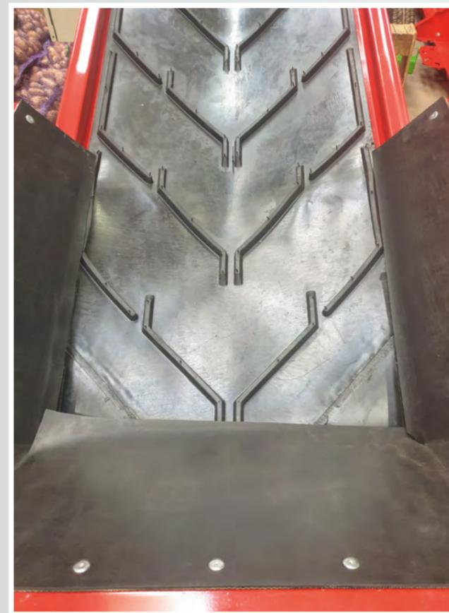
Конвейер наклонный КН-650 изготавливается только с изогнутым горизонтальным верхом («гуськом» как называют фермеры)
