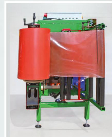
Машина **ПРЕДНАЗНАЧЕНА** для упаковки в полиэтилен (полурукав) корнеклубнеплодов, в том числе моркови, весом от 0,5 до 18 кг.
