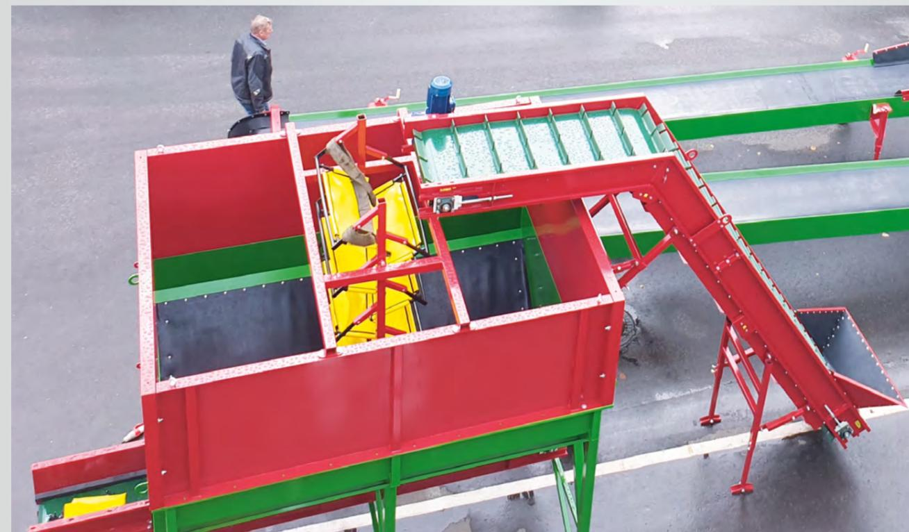
Бункер накопитель БНК 10/15/20 м<sup>3</sup> **ПРЕДНАЗНАЧЕН** для предварительного накопления продукта с его последующей подачей на производственную линию. Главной задачей бункеров накопителей является обеспечение бесперебойной работы линии предпродажной подготовки.
